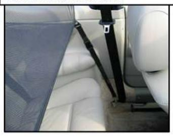
THE PLASTIC END SNAPS ON THE STRAP ATTACH TO THE END OF THE MIDDLE BAR
