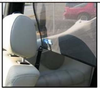
START BY LINING THE PLASTIC SLIDER UP WITH THE TOP OF THE ROLL BAR. THE STRAP WILL GO UNDER THE ROLL BAR
