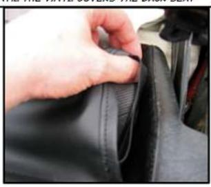
THE ELASTIC WILL FIT SNUGLY BETWEEN THE BACK SEAT AND THE PANEL. REPEAT ON THE OTHER SIDE
